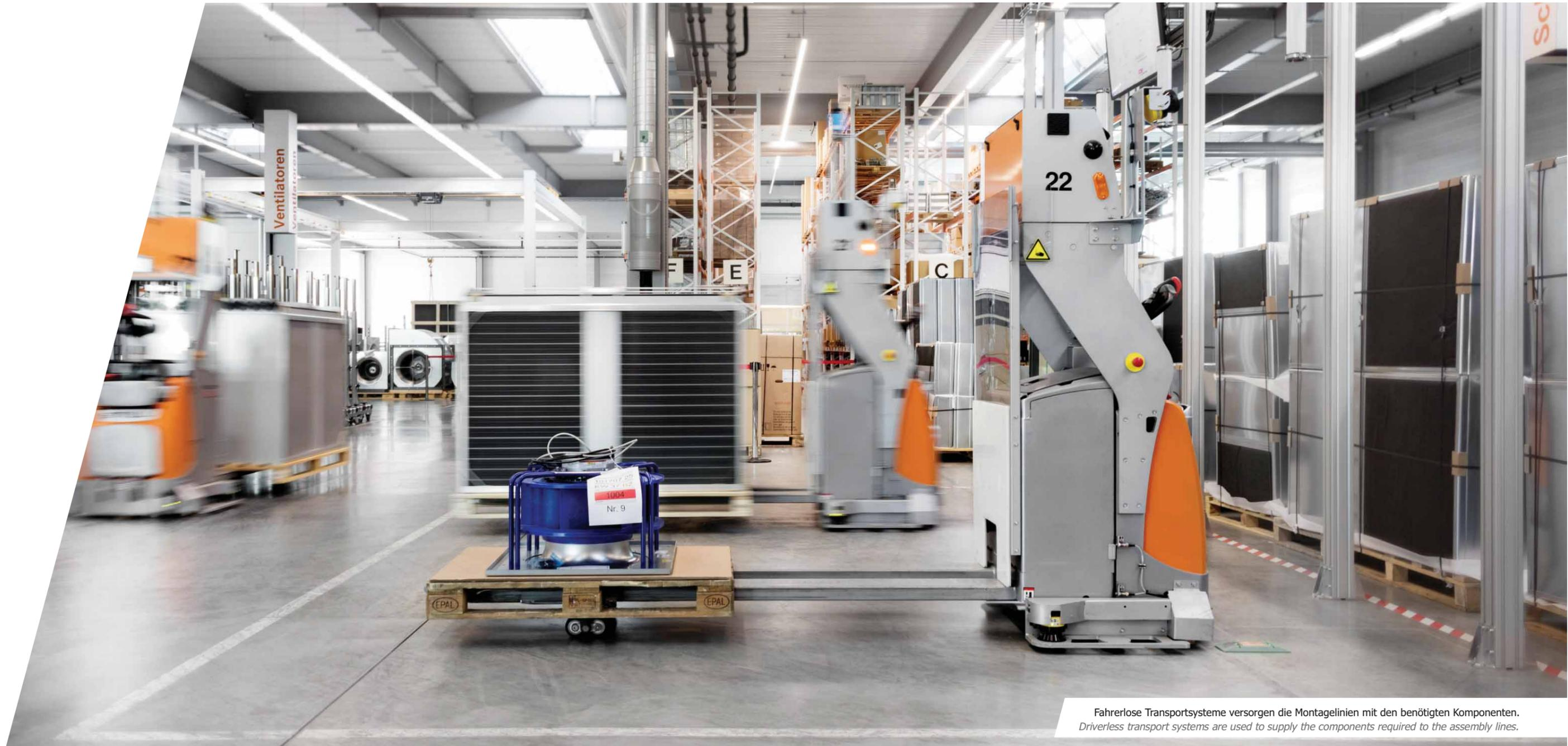
Fahrerlose Transportsysteme versorgen die Montagelinien mit den benötigten Komponenten.
